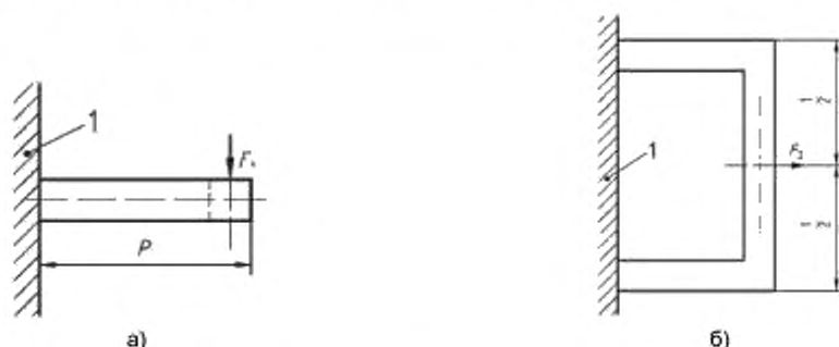
1 — стенка колодца; P — вылет ступени; F_v — вертикальная нагрузка; F_2 — горизонтальная растягивающая нагрузка
