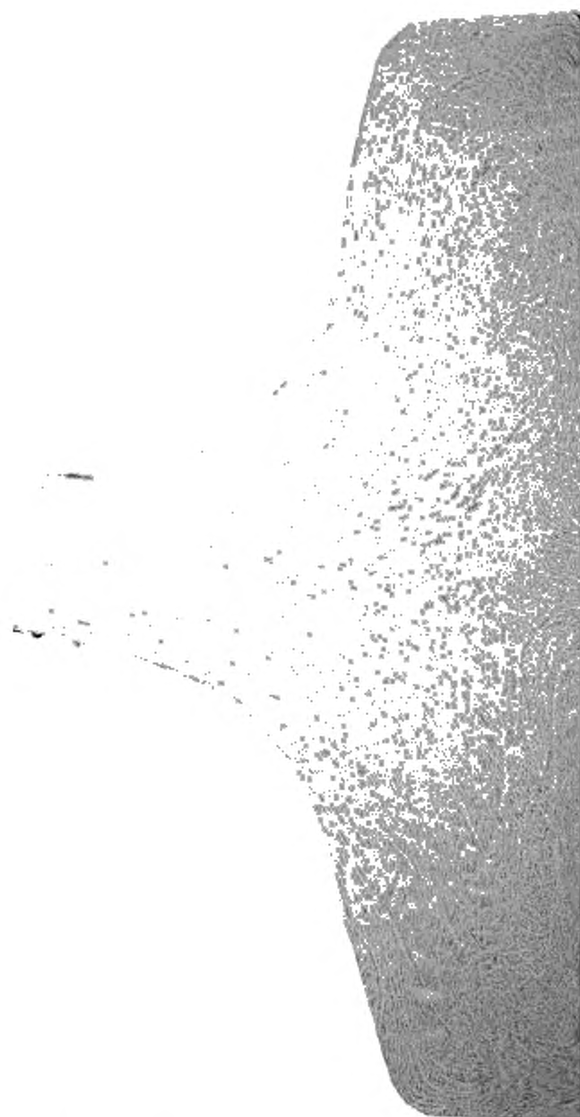
Рисунок А.3 – Эталон № 3 (однородная макроструктура ступицы колеса и центра)
