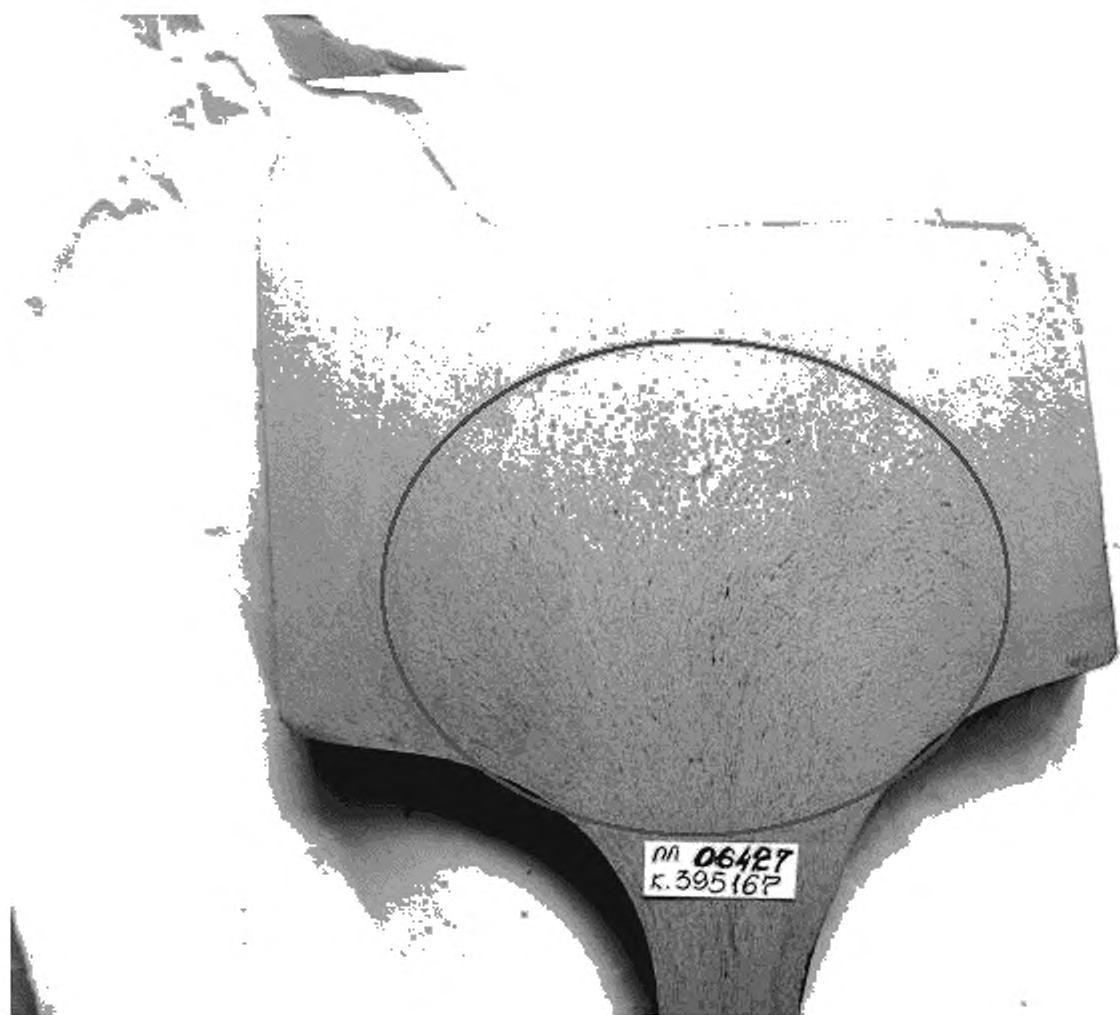
Рисунок Б.14 – Эталон № 14 (ликвационные полосы)
