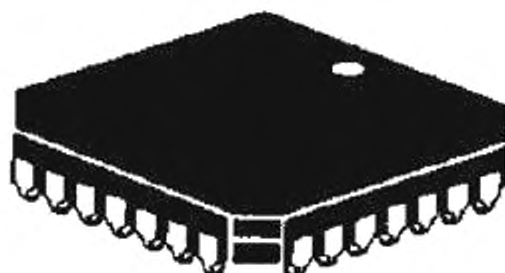
Рисунок 1 – Корпус QFJ (квадратный)
