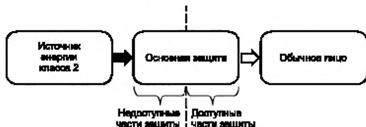
Рисунок 20 — Изображение доступных и недоступных частей основной защиты
