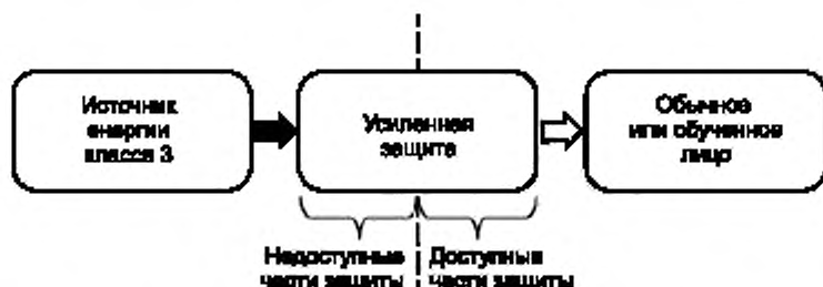
Рисунок 22 — Изображение доступных и недоступных частей усиленной защиты
