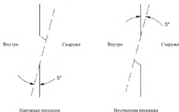
Рисунок Р.2 — Примеры конструкции заслонок
