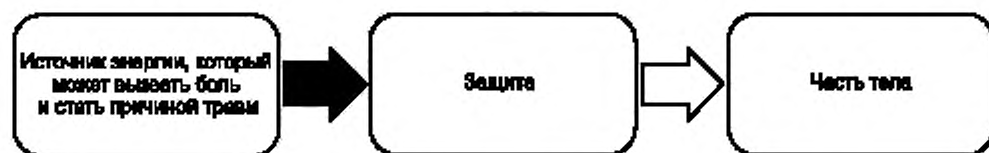
Рисунок 2 — Трехблочная модель защиты
