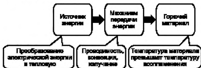
Рисунок 5 — Модель возникновения возгорания при воздействии электричества
