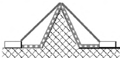
Рисунок O.4 — Промежуточная неподсоединенная проводящая часть
