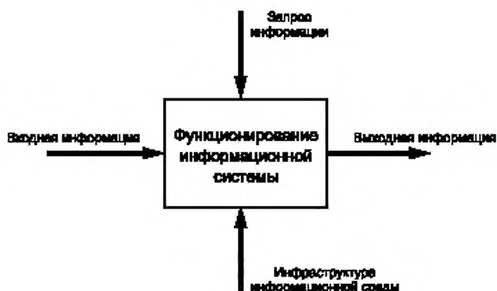
Рисунок Д.2 — Пример представления в функциональном моделировании с применением структурированных ТС в виде ИВВИО знакового обозначения функциональной модели информационной технической системы
