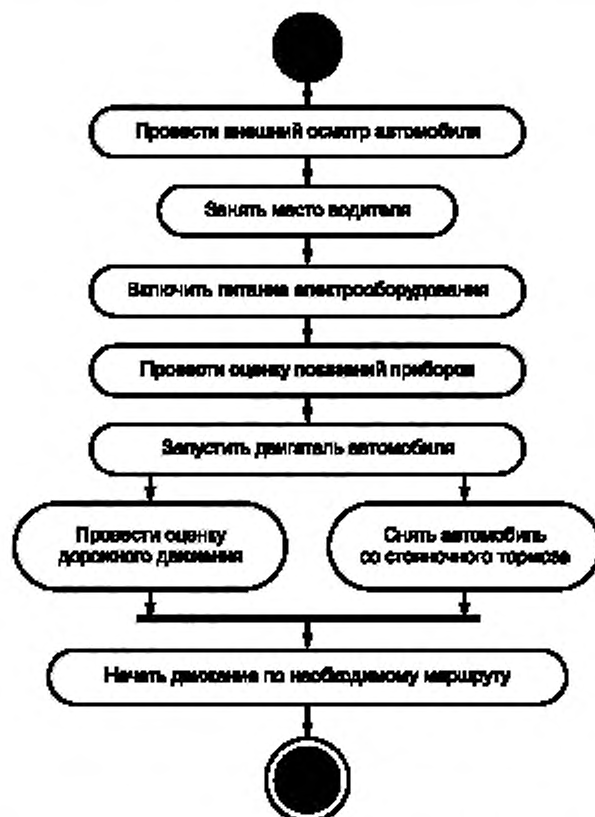
Рисунок К.1 — Пример представления деятельности водителя по управлению автомобилем на начальном этапе движения по необходимому маршруту с применением знаковых обозначений, используемых в визуальном проектировании ПО
