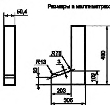
Рисунок 3 — Испытательное оборудование для проведения испытания моделью ноги
