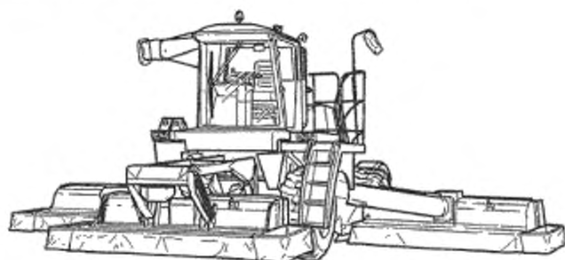
Рисунок С.3 — Самоходная ротационная косилка
