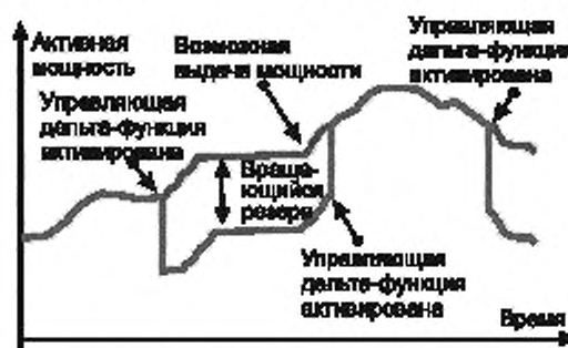
Рисунок В.4 – Схематическое изображение управляющей дельта-функции мощности
