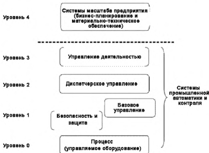
Рисунок 12 — Базовая модель по МЭК 62443
