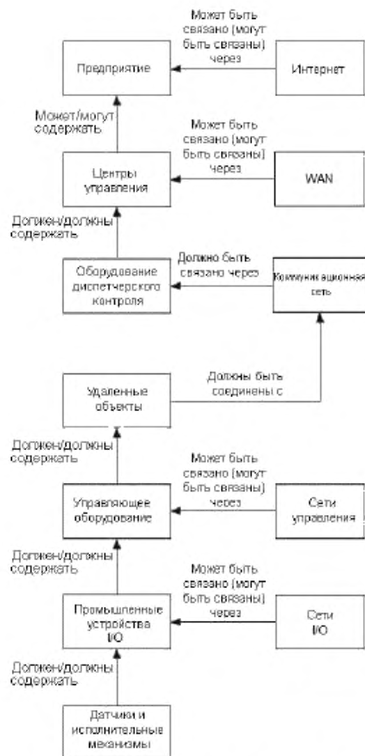
Рисунок 15 — Пример модели объектов системы SCADA
