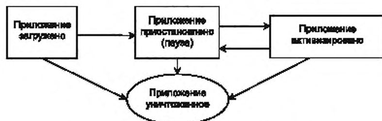
Рисунок 5 — Модель состояний виртуальной машины Xlet
