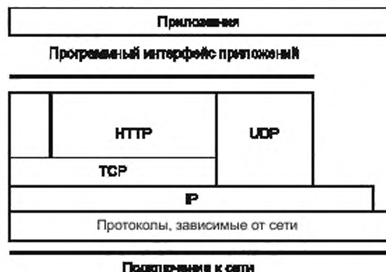
Рисунок 2 — Стек протоколов интерактивного канала
