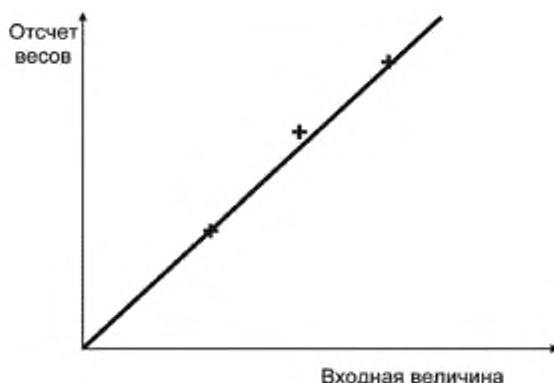
Рисунок 2 — Проверка линейности отсчета весов как функции входной величины
