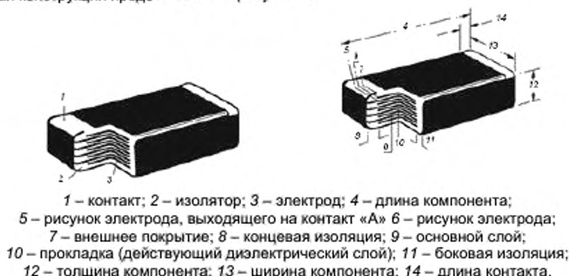
Рисунок 10 – Конструкция многослойного керамического безвыводного конденсатора
