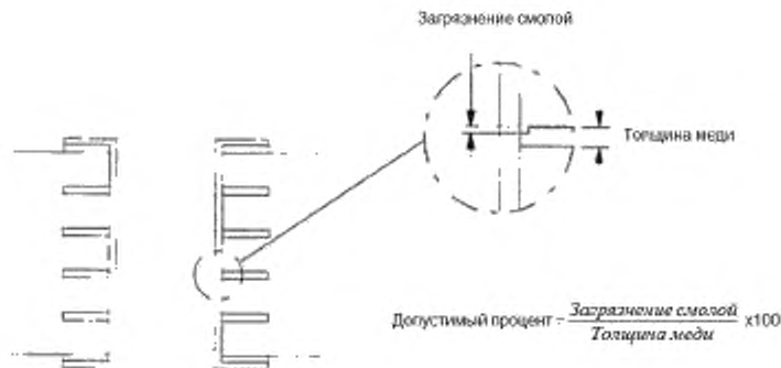
Рисунок 1 – Загрязнение смолой на поверхности раздела
