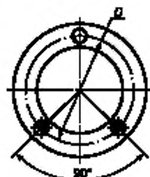
Рисунок 1 — Схема расположения отверстий на посадочной поверхности ССС мачтового, карликового и заградительного мачтового светофора
