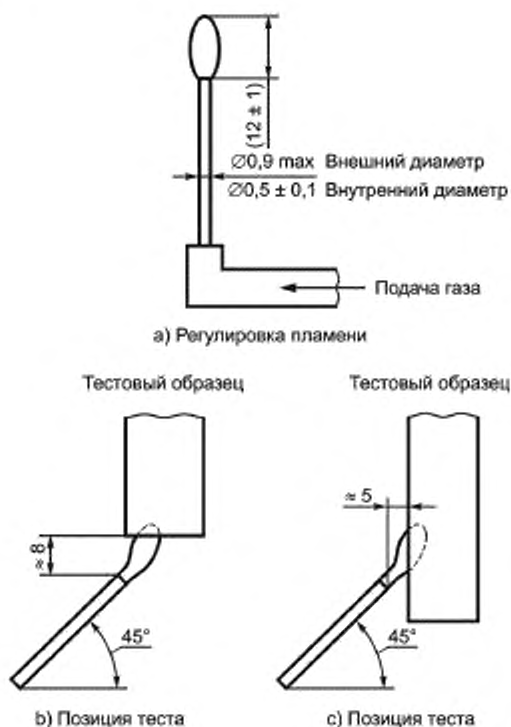
Рисунок В.3 — Детали испытания игольчатым пламенем
