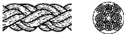
Рисунок 2 — Конфигурация 4-рядного крученого каната (тип В)
