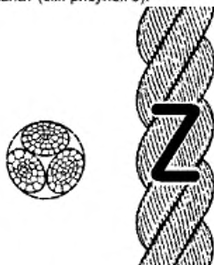
Рисунок 1 — Конфигурация 3-рядного крученого каната (тип А)
