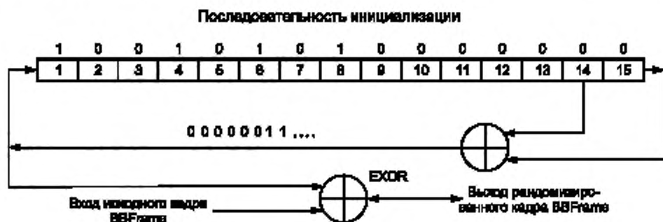
Рисунок 13 — Структурная схема возможной реализации кодера псевдослучайной последовательности
