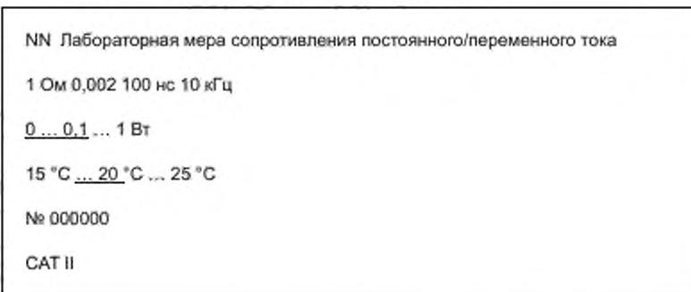
Рисунок 1 — Пример маркировки для однозначной меры сопротивления
