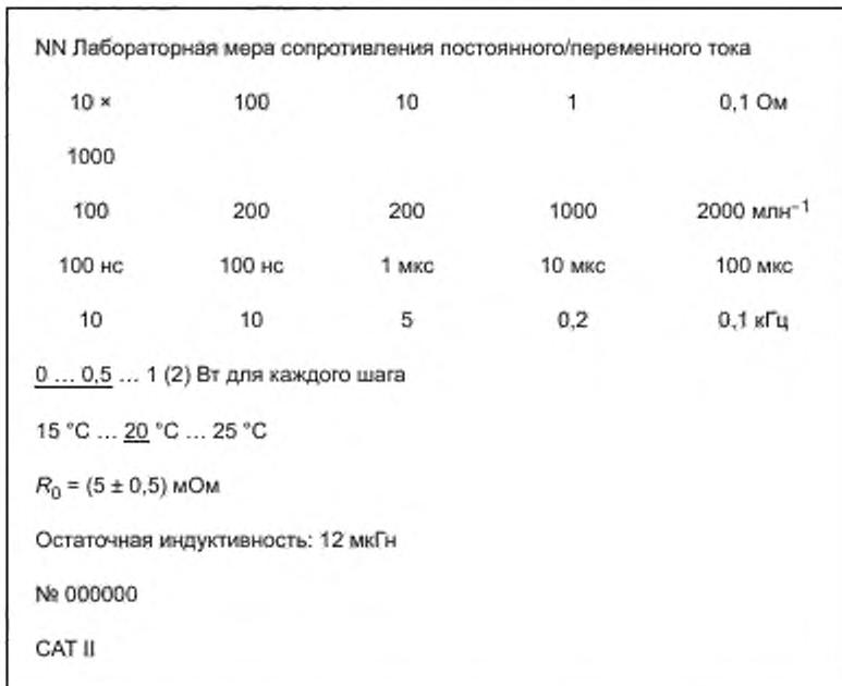
Рисунок 2 — Пример маркировки для пятидекадной меры сопротивления
