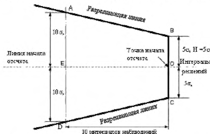
Рисунок 5 – Форма и размеры усеченной V-маски общего назначения
