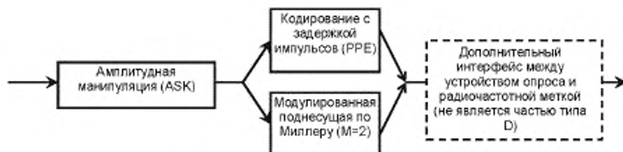
Рисунок 4 — Структура устройства опроса типа D
