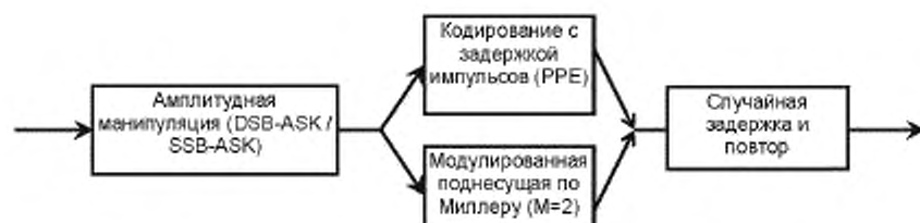
Рисунок 8 — Структура радиочастотной метки типа D
