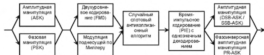
Рисунок 3 — Структура устройства опроса типа С
