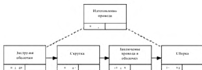
Рисунок В.6 – Блок-схема процесса изготовления проводов для изделия GT-350 [8]
