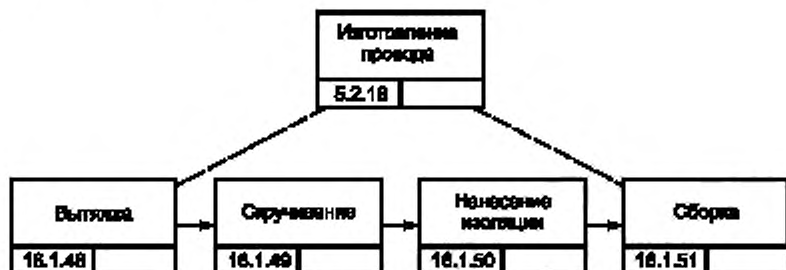
Рисунок В.6 — Процесс изготовления проводов изделия GT-350 [5]
