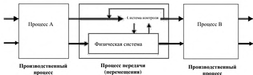
Рисунок 3 — Блок-схема процесса, поддерживающего потоки между производственными процессами А и В
