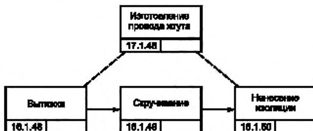
Рисунок В.5 — Процесс изготовления провода жгута
