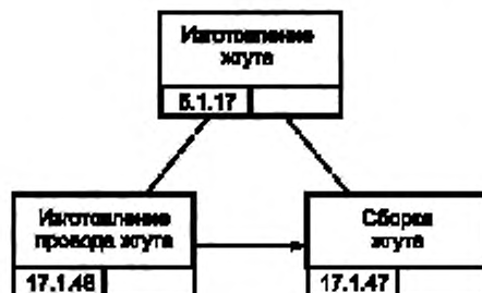
Рисунок В.4 — Процесс изготовления жгута изделия GT-350
