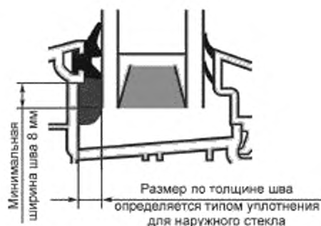
Рисунок 2 — Пример конструкции узла вклейки стеклопакета
