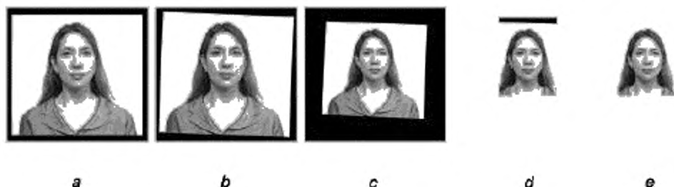
Рисунок В.8 — Аффинное преобразование и кадрирование
