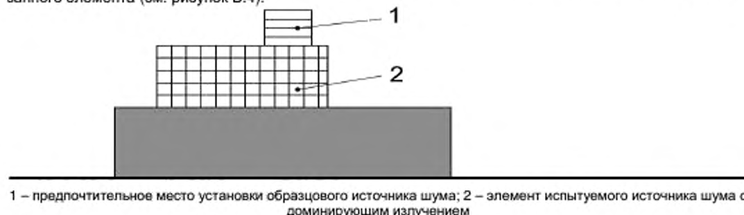
Рисунок В.3 – Место расположения образцового источника шума при наличии у испытуемого источника шума элемента с доминирующим ненаправленным излучением
