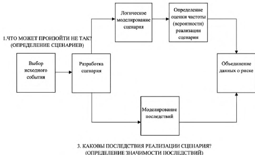
Рисунок 3 – Три компонента определения риска в методе PRA
