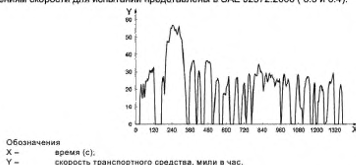
Рисунок С.1 — Последовательность испытаний транспортного средства, имитирующих городское движение в условиях США, в соответствии с городским динамометрическим циклом движения (UDDS)
