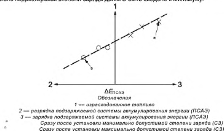
Рисунок L.1 — Рекомендуемая последовательность испытаний для получения основных данных
