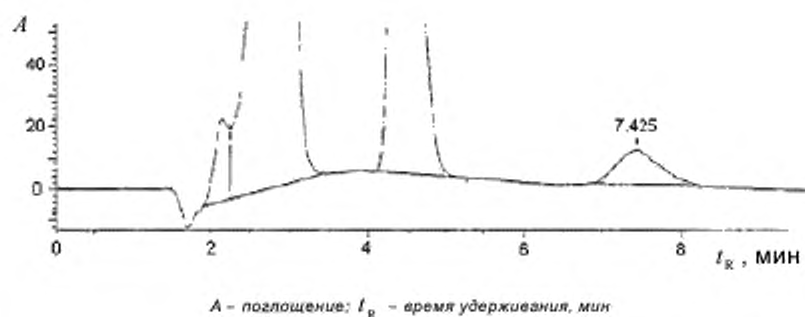
Рисунок В.4 – Хроматограмма, полученная на УФ детекторе при длине волны \lambda = 242 нм для МР-производного 2,4-TDI
