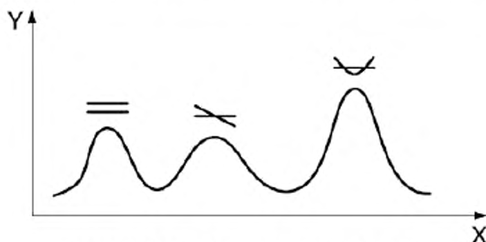
X – частота вращения ротора; Y – амплитуда вибрации
