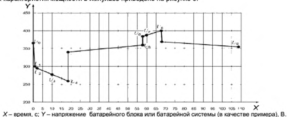
Рисунок 6 — Снятие характеристик мощности в импульсе (график по напряжению).
