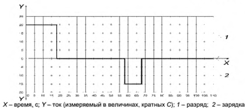
Рисунок 5 — Снятие характеристик мощности в импульсе (график по току)
