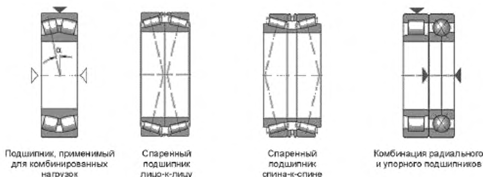
Рисунок 26 — Примеры расположений упорных подшипников
