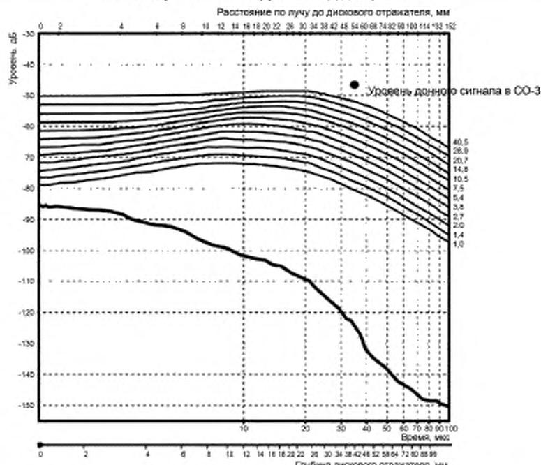
За уровень 0 дБ принята амплитуда импульса возбуждения преобразователя (20 В). Разметка времени по горизонтальной оси соответствует распространению сигнала только в материале объекта контроля. Справа от кривых АРД указана площадь соответствующего дискового отражателя в квадратных миллиметрах.
