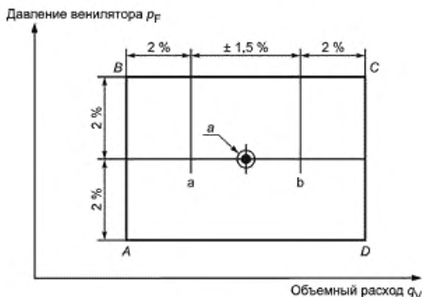
Рисунок 33 — Типичный пример зависимости погрешности создаваемого давления вентилятора от объемного расхода
