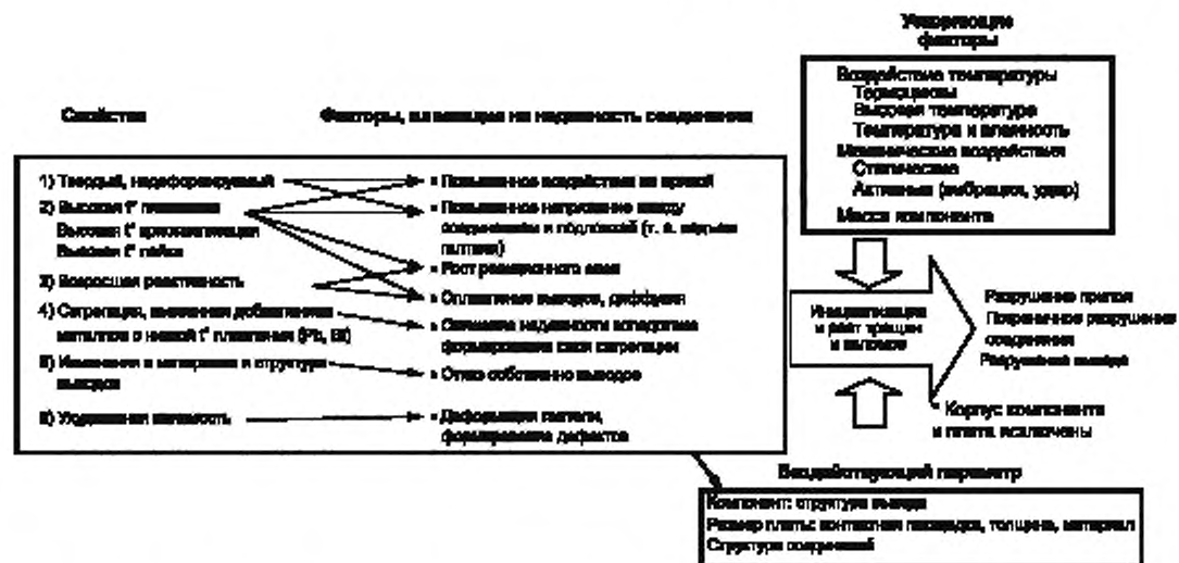
Рисунок 2 — Факторы, влияющие на надежность соединений, выполненных бессвинцовым припоем
