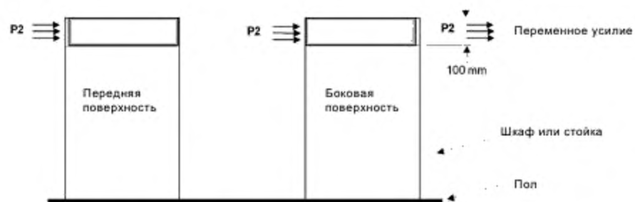
Рисунок 2 - Испытание шкафов и стоек на жесткость
