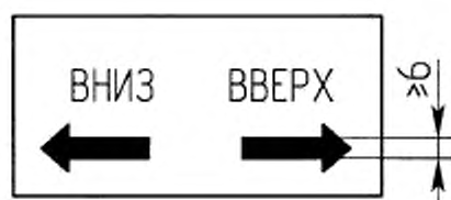
Рисунок 3 – Образец таблички с указанием направления перемещения
