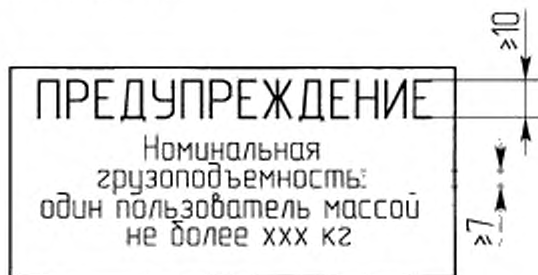
Рисунок 15 - Образец стандартной надписи с информацией о грузоподъемности
