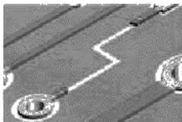
Рисунок 21 а — Удаление покрытия с концов проводников
