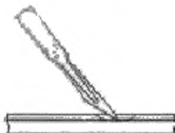
Рисунок 24 а — Удаление защитного слоя
