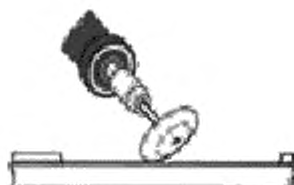
Рисунок 24 с — Удаление шлифовальным инструментом
