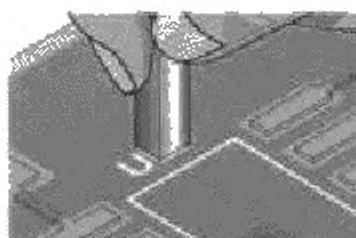
Рисунок 7 а — Нанесение маркировки штампом
