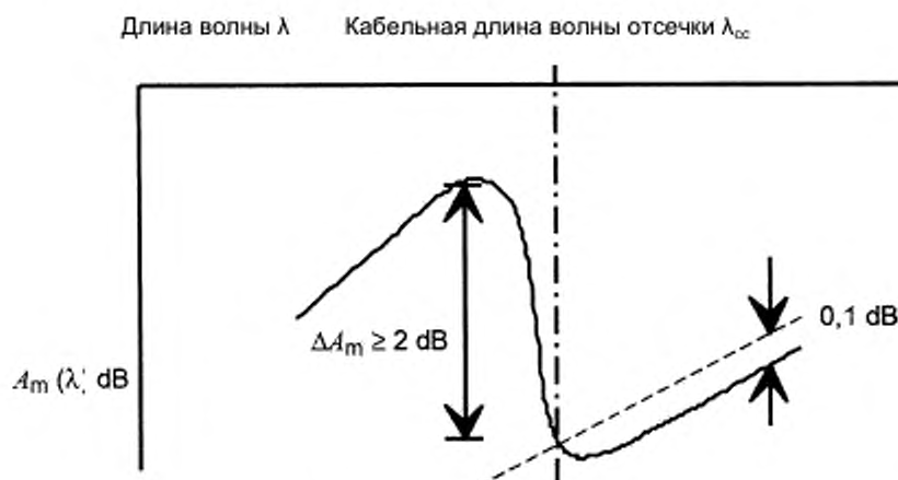
Рисунок 6 — Измерение длины волны отсечки при использовании методики эталонного многомодового волокна
