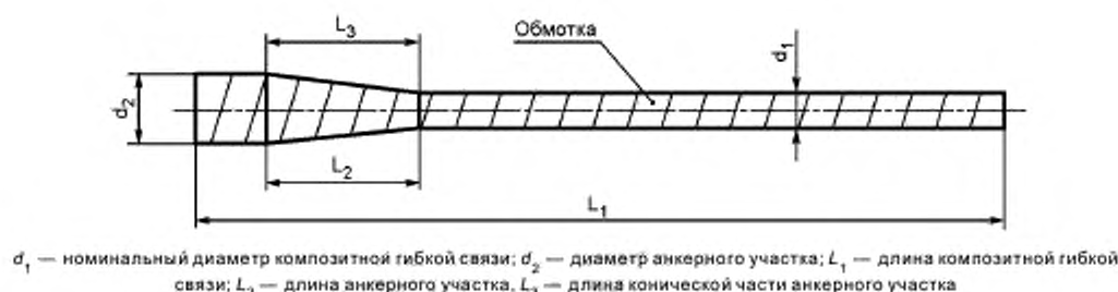
Рисунок Л.1 — Композитная гибкая связь с выделенным цилиндрическим анкерным участком
