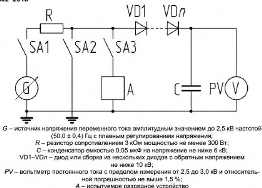
Рисунок 1 – Схема для проверки напряжения срабатывания разрядного устройства
