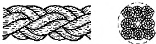
Рисунок 3 – Конфигурация 8-рядного плетеного каната (тип L)
