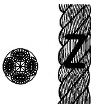
Рисунок 2 – Конфигурация 4-рядного (shroud-laid) каната (тип B)
