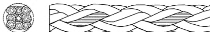
Рисунок 1 — Конфигурация 8-прядного плетеного каната (тип L)
