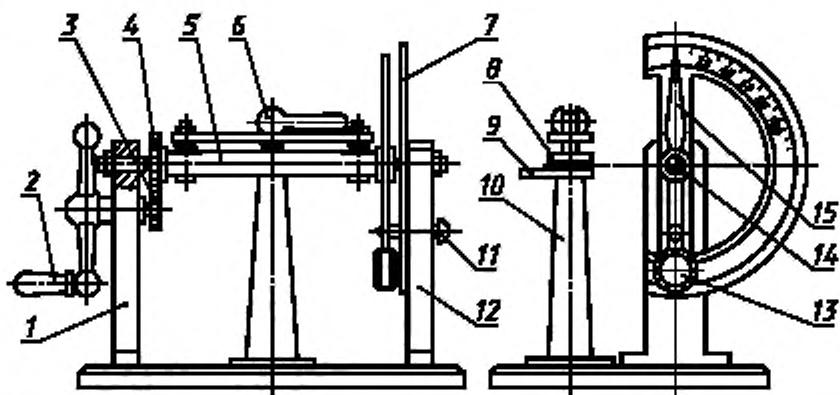
Прибор состоит из шпинделя 14, вставленного в трубку 5 с продольными шлицами для закрепления образца. Трубка и шпиндель свободно посажены на осевых опорах, укрепленных на стойках 1 и 12, и приводятся во вращение с помощью рукоятки 2 через шестеренки 3 и 4. К шпинделю прикреплена стрелка 15 с грузом 13 на конце.
