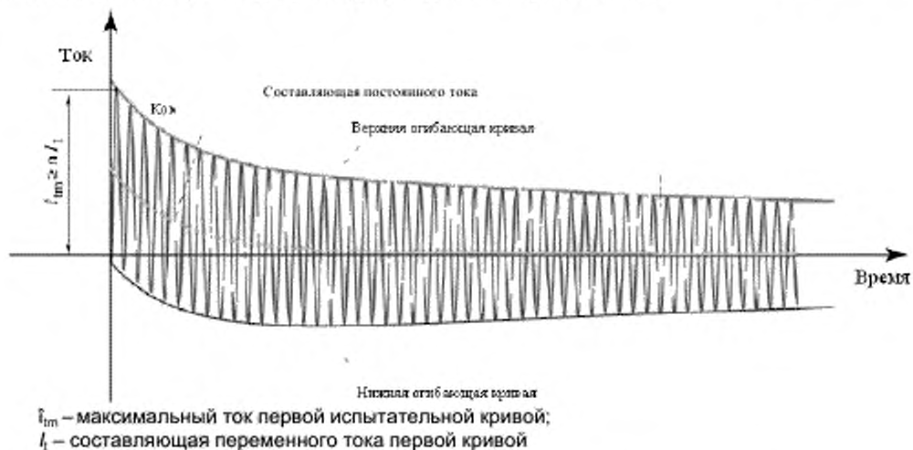
Рисунок 9 – Форма тока короткого замыкания во время испытания
