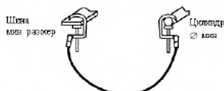
Рисунок 5с — Комбинация шины и цилиндра минимального размера
