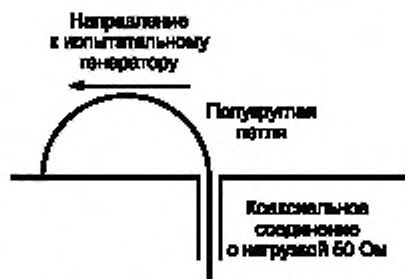
Рисунок D.3 — Полукруглая петля на пластине заземления
