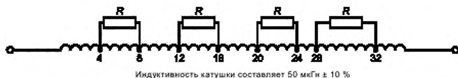
Рисунок А.3 — Схема катушки индуктивности 50 мкГн
