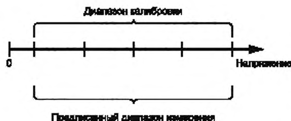
Рисунок 2 — Калибровка методом сличения в полном специфицированном диапазоне измерения
