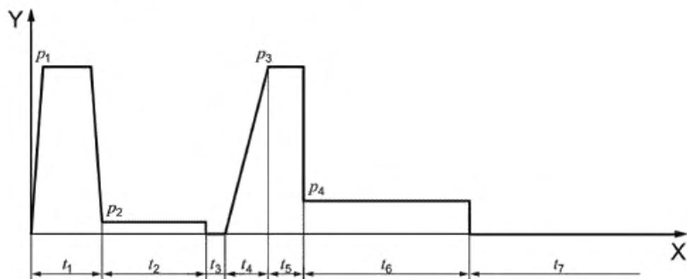
$X$  — время;  $Y$  — давление;  $t_1$  — время выравнивания;  $t_2$  — время прогрева;  $t_3$  — технологическая пауза;  $t_4$  — время подъема давления;  $t_5$  — время сварки;  $t_6$  — время охлаждения в машине при пониженном давлении;  $t_7$  — время охлаждения в машине без давления или вне машины;  $p_1$  — давление выравнивания;  $p_2$  — давление прогрева;  $p_3$  — давление при сварке;  $p_4$  — пониженное давление при охлаждении в машине
