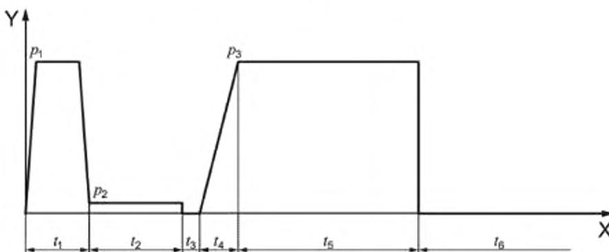
X — время; Y — давление;  $t_1$  — время выравнивания;  $t_2$  — время прогрева;  $t_3$  — технологическая пауза;  $t_4$  — время подъема давления;  $t_5$  — время охлаждения в машине под давлением;  $t_6$  — время охлаждения вне машины;  $p_1$  — давление выравнивания;  $p_2$  — давление прогрева;  $p_3$  — давление сварки
