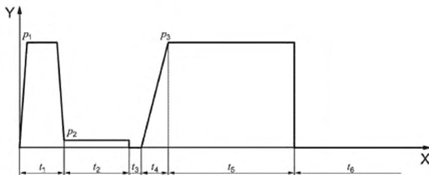
Х — время; Y — давление;  $t_1$  — время выравнивания;  $t_2$  — время прогрева;  $t_3$  — технологическая пауза,  $t_4$  — время подъема давления;  $t_5$  — время охлаждения в машине под давлением;  $t_6$  — время охлаждения вне машины;
