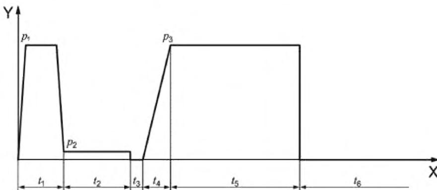
Х — время; Y — давление;  $t_1$  — время выравнивания;  $t_2$  — время прогрева;  $t_3$  — время технологической паузы;  $t_4$  — время подъема давления;  $t_5$  — время охлаждения в машине под давлением;  $t_6$  — время охлаждения в машине без давления или вне машины;  $p_1$  — давление выравнивания;  $p_2$  — давление при прогреве;  $p_3$  — давление при сварке
