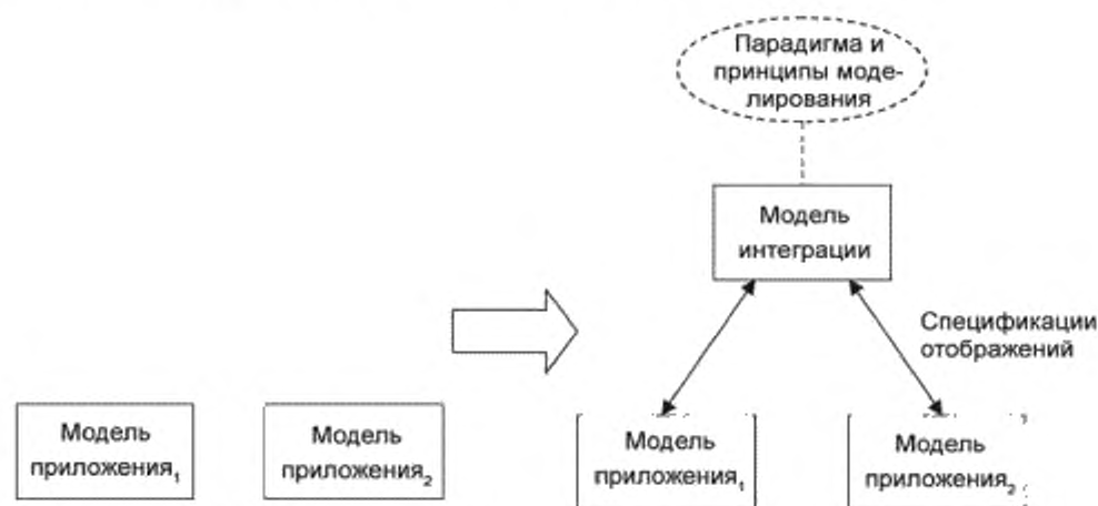
Рисунок 1 — Создание модели интеграции, интегрирующей две модели приложений
